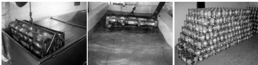
Figuras 10,11,12: tratamento térmico, resfriamento e quarentena
