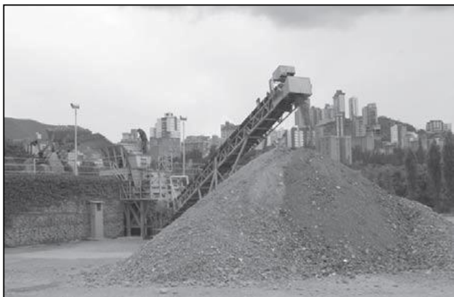
Figura 41 – Máquina de Trituração de Resíduos da Construção Civil
