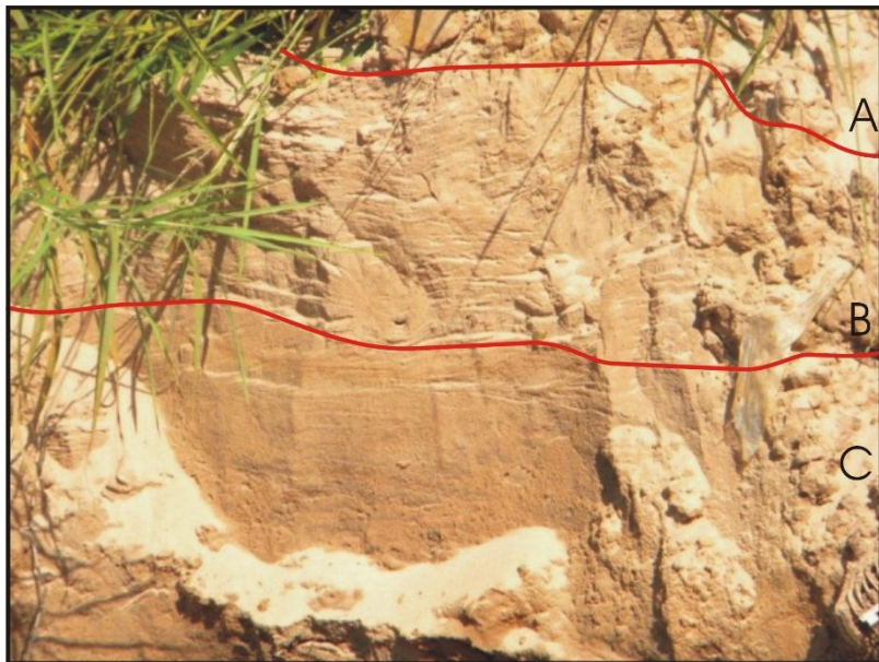
Figura 36 – Depósito Tecnogênico Lagunar com Materiais Terrígenos
